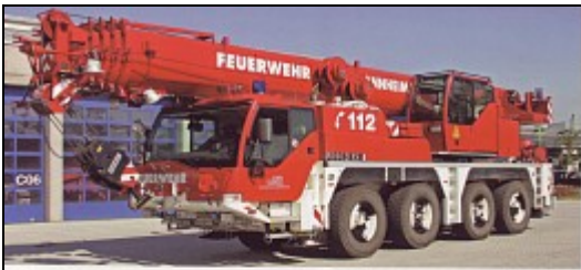
Zu den größten Sonderfahrzeugen der Feuerwehre gehören Feuerwehre-Kranen (FKV). Der KVV der Berufsfeuerwehr München verfügt über zwei 42-Meter-Teleskoparme mit 42 Metern Länge über eine Hubhöhe von 33,5 Metern. Er kommt bei Absturzsicherungen nach Verkehrsunfällen mit Einst- und Schwengefahrgefahren, Absturzsicherungen nach Einsturz von Gebäuden, Brücken oder Erdschichten, bei Rettungsaktionen bei Hoch- und Niederwasserständen, zur Ausrüstung von Masten und Türmen, zur Unterstützung der Rettungsaktionen sowie zum Schützen und Ziehen von Fahrzeugen und Lasten, zum Sichern von Kränen und Gegenkräften und für den Abrissbetrieb.
