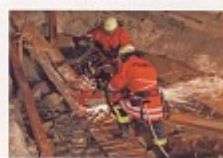
Trennschleifer (auch: Wickelschleife, „Lila“) werden im Bereich der Einsatzstelle für Rettungs- und Bergearbeit eingesetzt. Sie ermöglichen vor allem das Durchtrennen von Stahlbeton, aber auch von Stein und anderen Werkstoffen.
